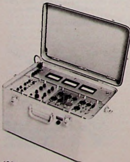
Stand 23 Miniatuur analoge simulator van Sfena: Potmeter-slagenteller met cijferindicatie in de knop.
