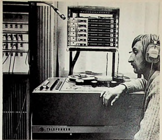
Afb. 2. Achtsporenmagnefoon met de Doloy-A-companders. Op het moment van de opname waren er slechts zes aanwezig.
